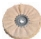
POLÍROZÓGYŰRŰK, SZIZÁL/POSZTÓ színesfémek finomcsiszolásához/és karcmentesítéséhez, előcsiszolás 240-280-as szemcsemérettel utána pasztával. - Vas/acél és rozsdamentes acél finomcsiszolásához/és karcmentesítéséhez, előcsiszolás 280-320-as a pasztával mattítani a színesfémeket, acélt és rozsdamentes acélt. Az acél/rozsdamentes acél előpolírozása a pasztával lehetséges - 30 mm széles, 14 mm-es furattal
