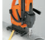
TALP CSÖVEK FÚRÁSÁHOZ szorítóhevederrel ellátva, amelyek segítségével csöveket lehet pontosan fúrni, Ø 60-tól 300 mm-ig, 220 x 130 mm.
