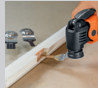
A keményfém reszelők ideálisak bordák, hornyok, rések és korcok tiszta kireszeléséhez.
