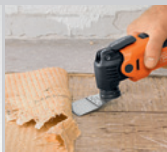
A merev spaklival padlószőnyeget és ragasztóanyag-maradékot is eltávolíthat egyszerűen, maradék nélkül.
